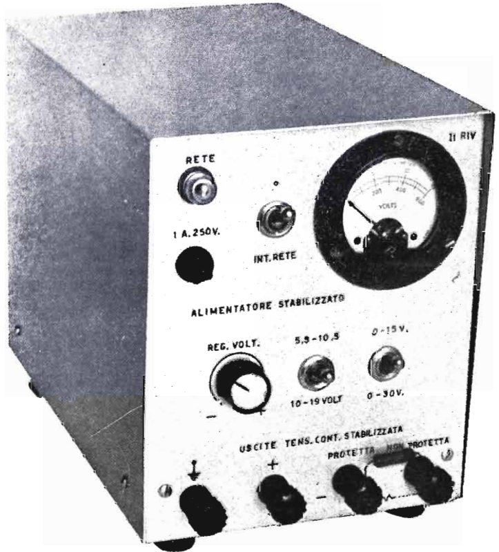
Pannello frontale alimentatore stabilizzato 5,5 ÷ 19 V.
